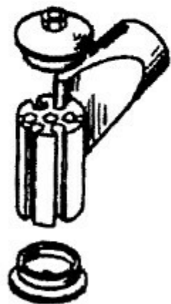
Рис. 3.7. Комбинированное узловое сопряжение стержневых структурных плит «Триодетик»
