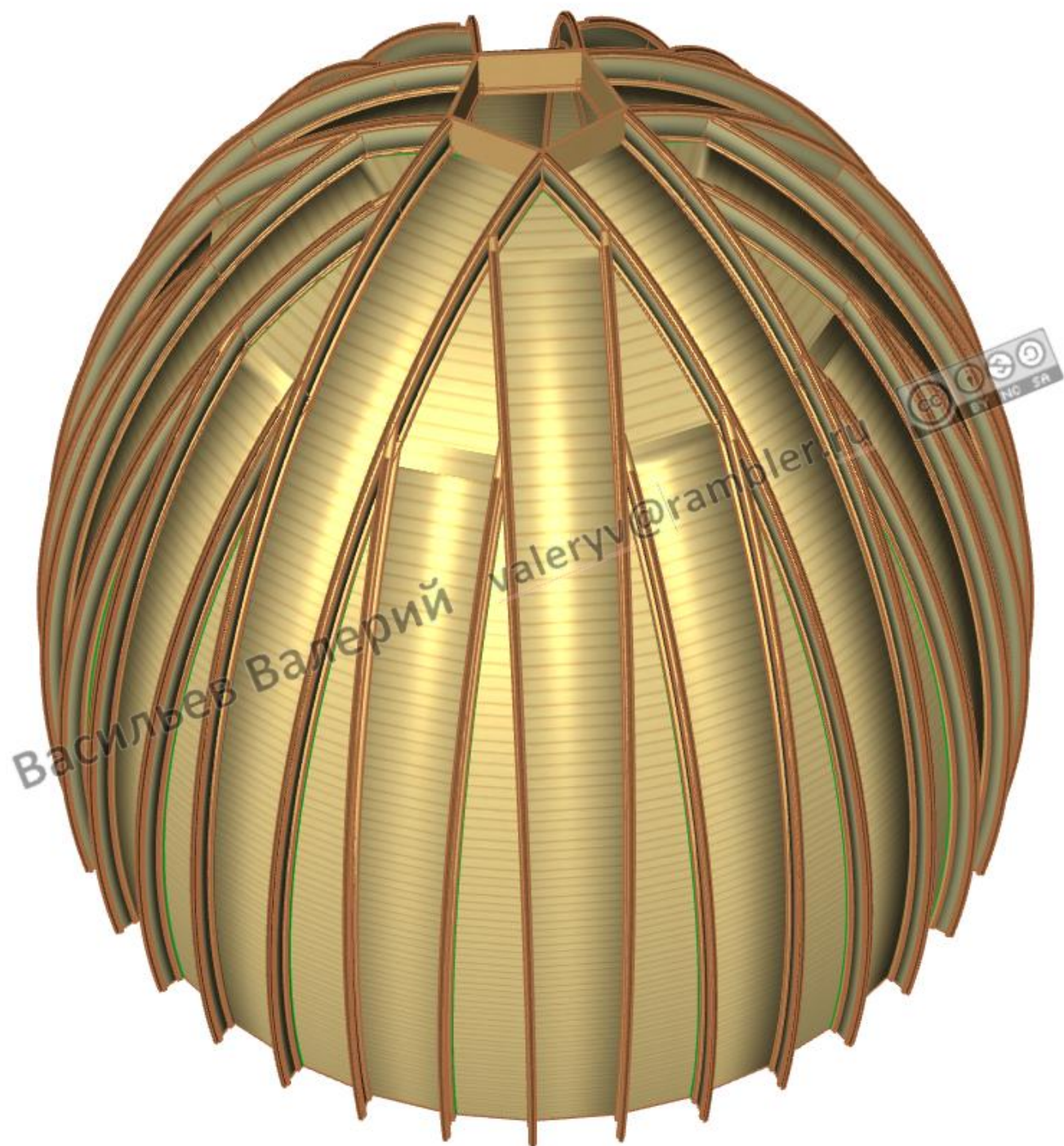
Рис. 13в Дощатая внутренняя обшивка пятилепесткового купола вид снаружи без внешней оболочки
