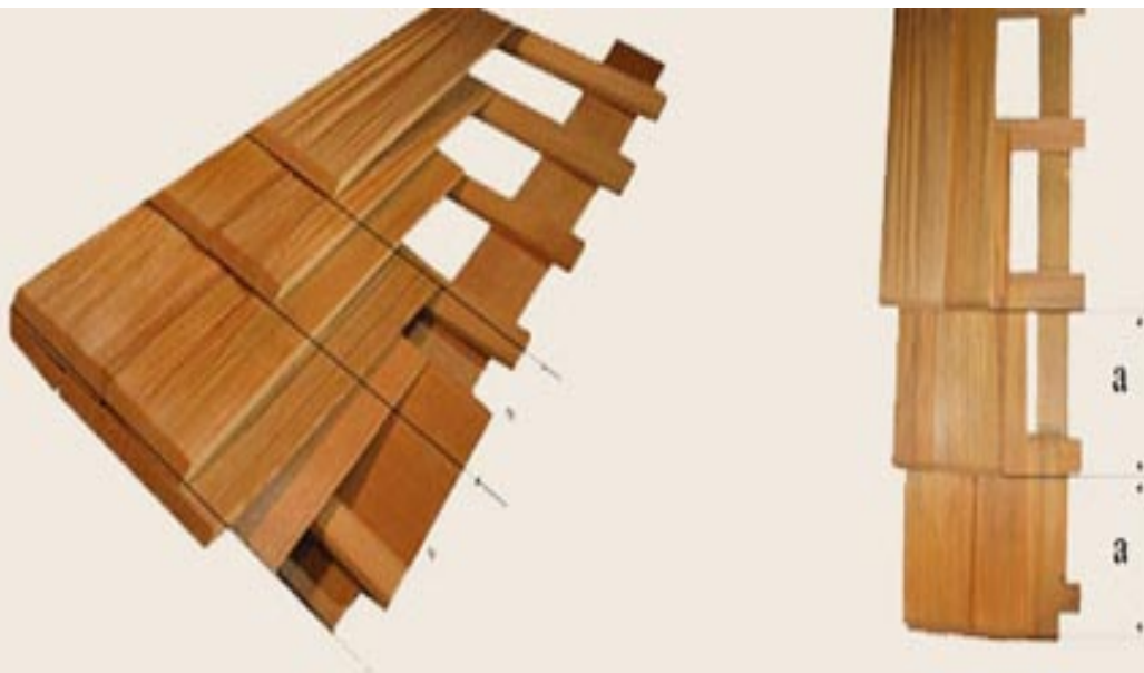
Монтаж деревянной черепицы на сплошной настил.
