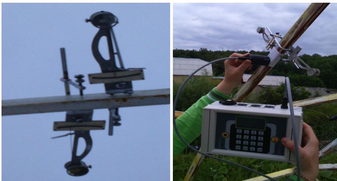
Рис.4.29. Спаренные тензометры Гугенберга на элементах пяти направлений СМК.
