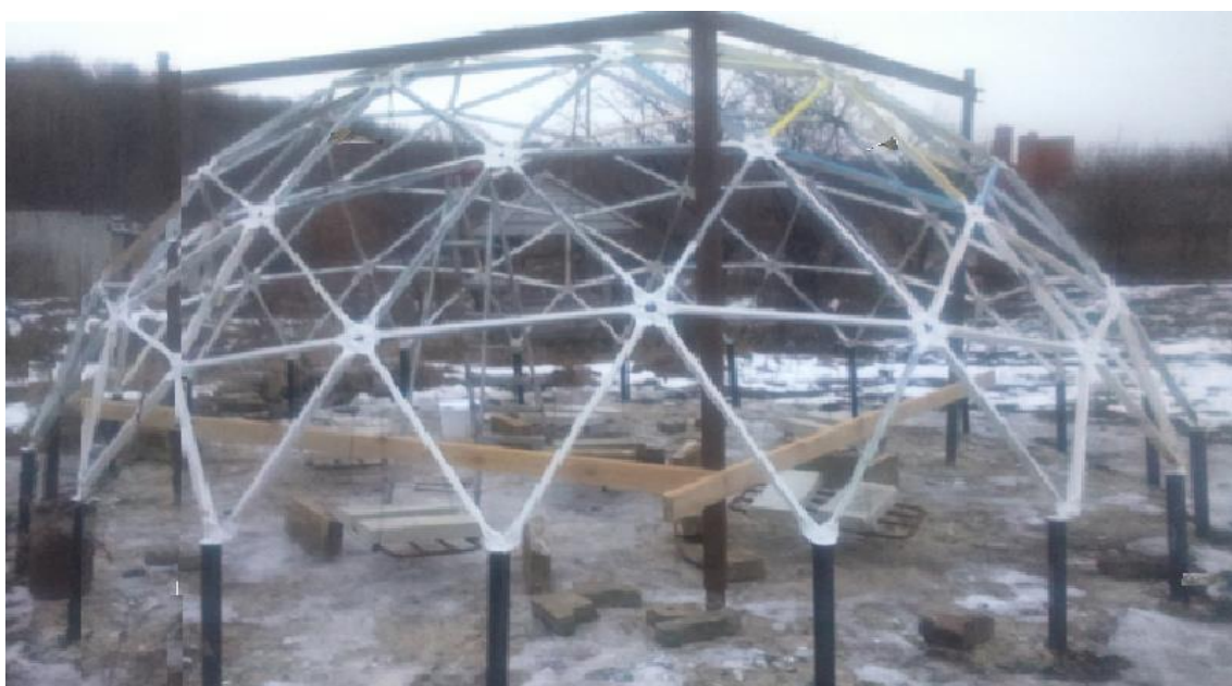
Рис.4.28. Экспериментальная установка с моделью стального купола в сборе.
