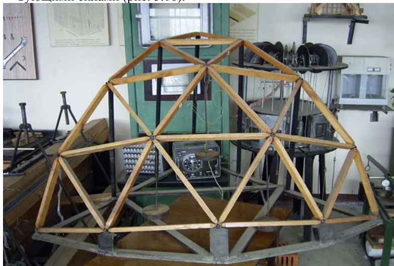
Рис. 5.16 Установка для испытания сферического купола
