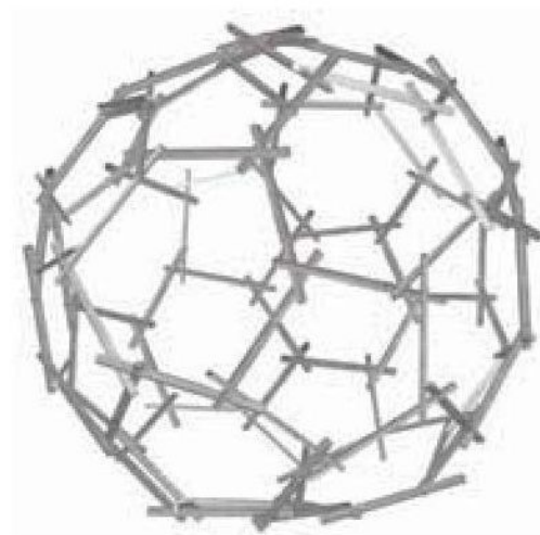
Рис.15. Пространственная сферическая конструкция с тремя деревянными балками: а – принцип трех рычагов; б – окончательная конструкция
