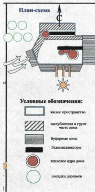
Рисунок 2.55- Схема теплового зонирования усадебного жилища на рельефе
