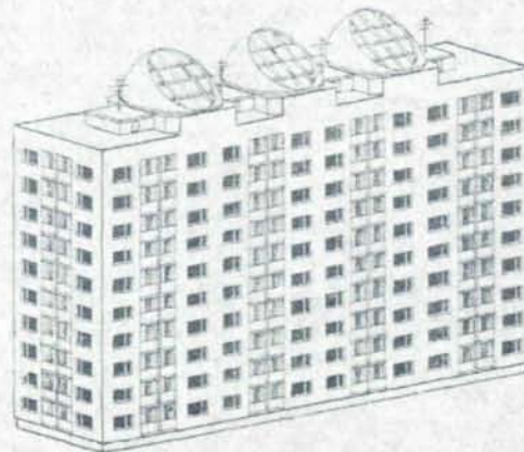
Рисунок 1.71 - Проект солнечного дома д.т.н. Селиванова Н.П. (СССР). Жилое здание снабжено вращающимися гелиоловушками с внутренними отражателями
