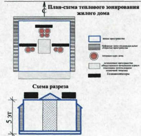
Рисунок 2.65- Схема теплового зонирования точечного секционного жилища
