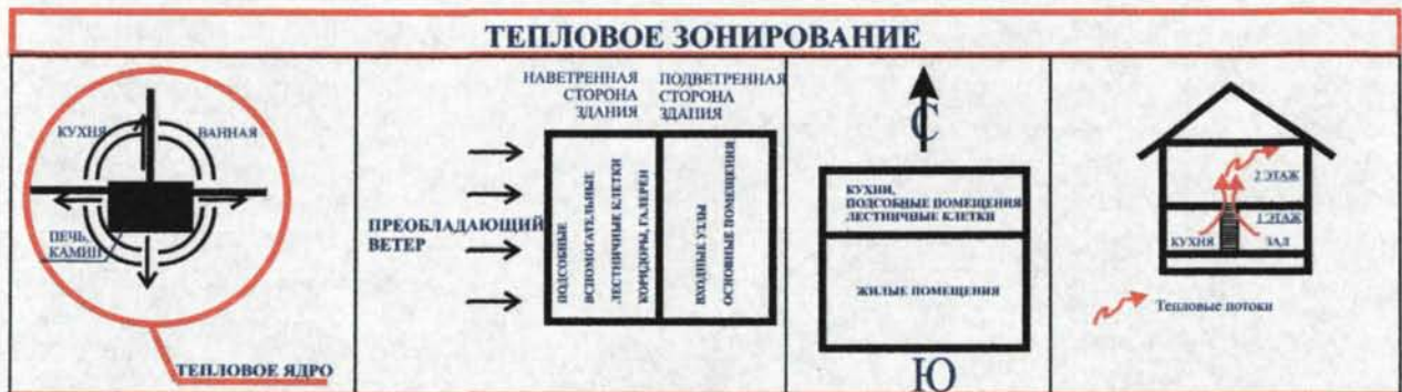
Рисунок 2.73- Осуществление теплового зонирования при определении внутренней планировки ЭЖЗ малой и средней этажности
