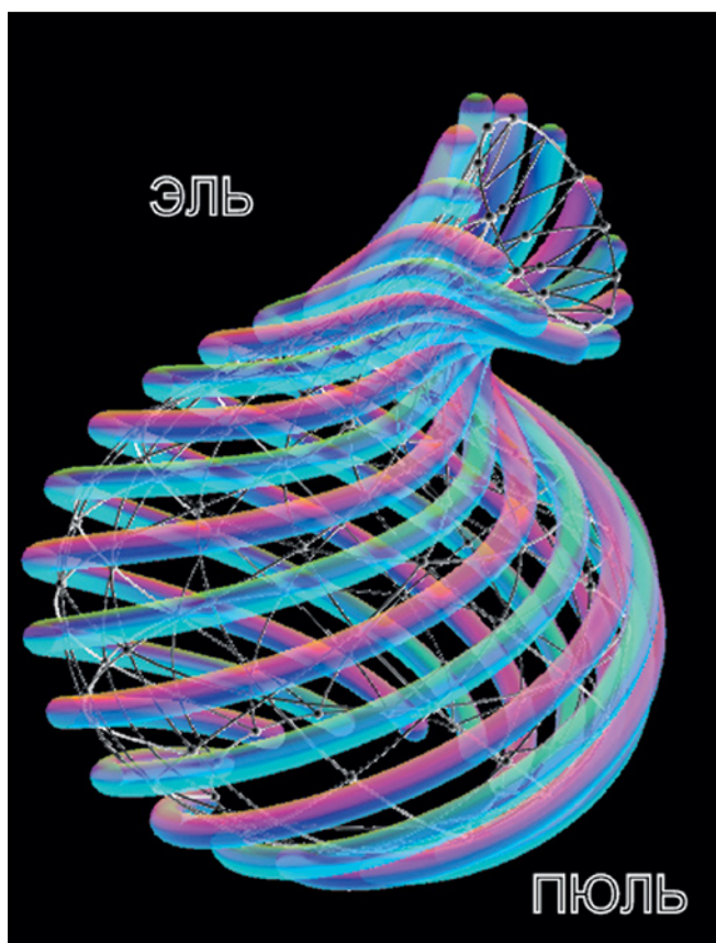
Конструкция «эльпюль», сочетающая в себе два вида поверхностей — гиперболическую (вогнутую) «эль» и выпуклую (эллиптическую) — «пюль».
