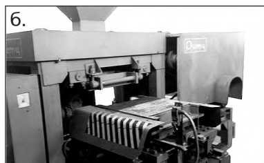
Рис. 4.11. Установки зонного нагнетания для формирования грунтоблоков:
