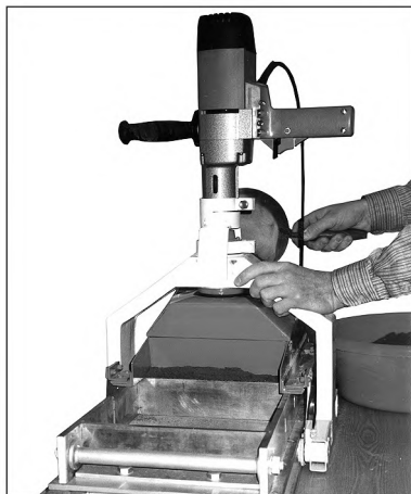
Рис. 7.3. Процесс формования. Нагнетающую насадку перемещают вдоль формы вслед за выпираемой бетонной смесью, до заполнения всех формообразующих ячеек и выхода рабочего органа за пределы формы.
