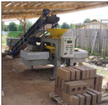
Рис. 8.1. Комплект оборудования на базе РК 250, установленный непосредственно на месте строительства и изготовленные на нём блоки.
