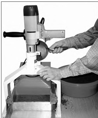
Рис. 7.2. Начало формирования бетонного изделия. Постоянно подсыпая бетонную смесь, ждут момента обратного его выпирания перед рабочим органом и выше нижнего положения его конической поверхности.
