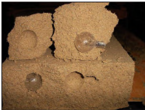
Рис. 4.7. Результат эксперимента изготовления грунтового блока с предварительно помещёнными в форму лампочками.
