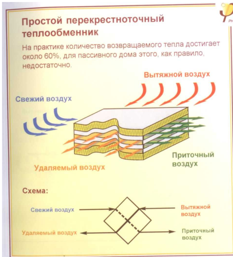
Рис.18.1. Принцип рекуперации тепла. Простой перекрестноточный теплообменник
