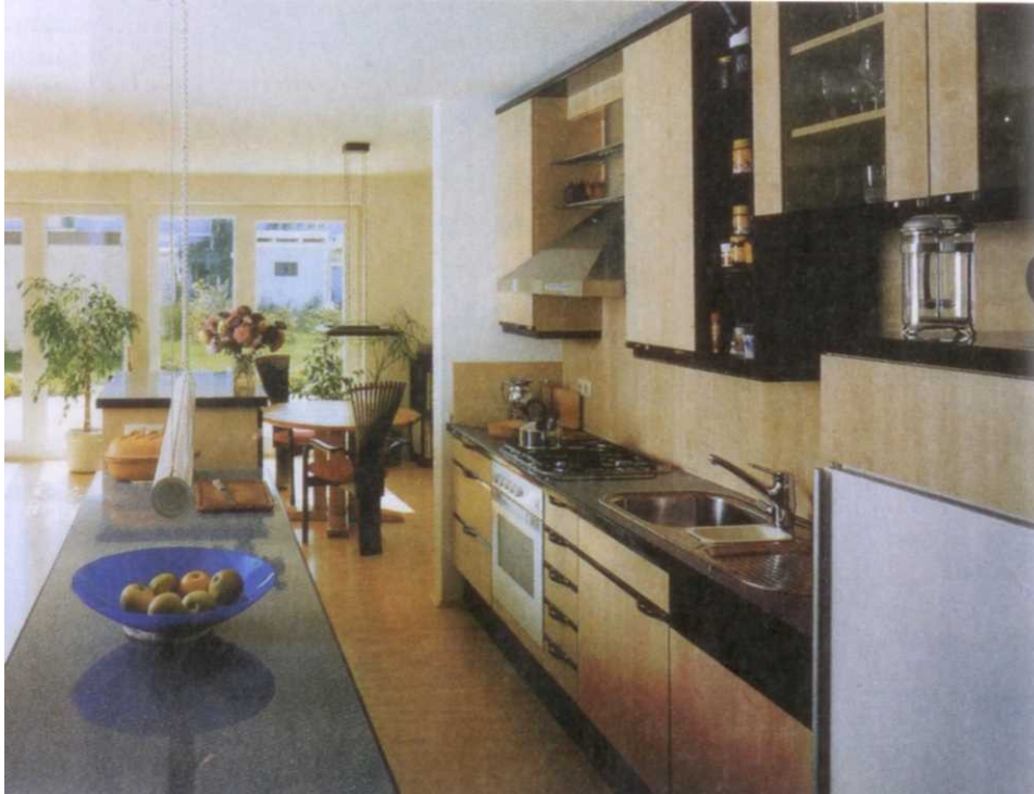
Рис. 24. Вид на жилую квартиру в одной из четырех квартир в пассивном доме в г. Дармштадте, р-н Кранихштайн. Через большие окна южной ориентации полностью открывается вид на наружный пейзаж. Поступления пассивной солнечной энергии с декабря по январь превышают теплопотери через эти окна
