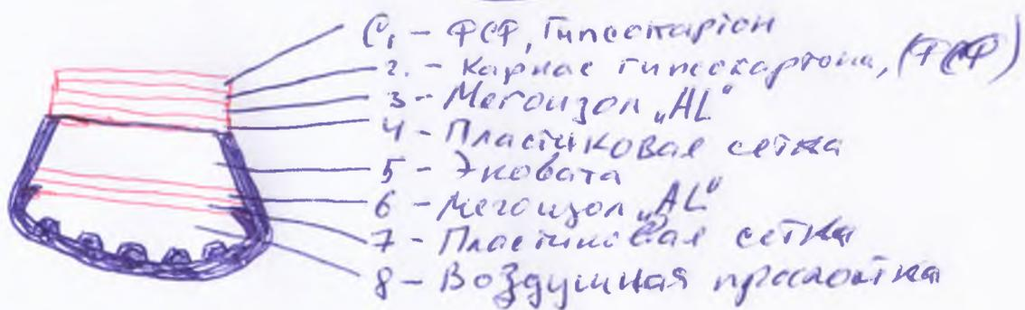
Надо сделать треугольник в виде подкова с толщиной стенки 30-40мм. из (С.Ф.Б) стеклофибробетона.
