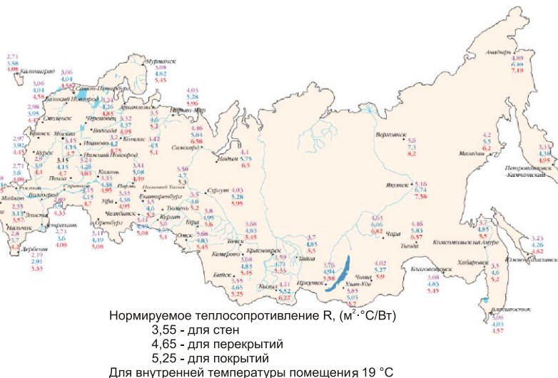
Рис. 2.11. Нормированные значения коэффициента сопротивления теплопередаче для различных регионов России в соответствии с действующими СНиП
