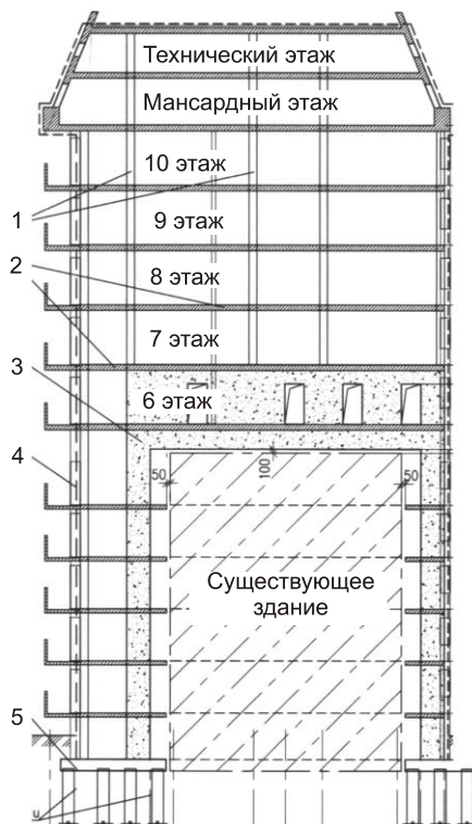
Рис. 1.2. Принципиальная схема конструктивных решений ДВЗ
