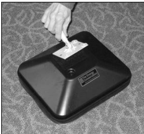
Рис. 2.38. Диагностическая заглушка для проверки герметичности воздуховодов систем вентиляции и кондиционирования
