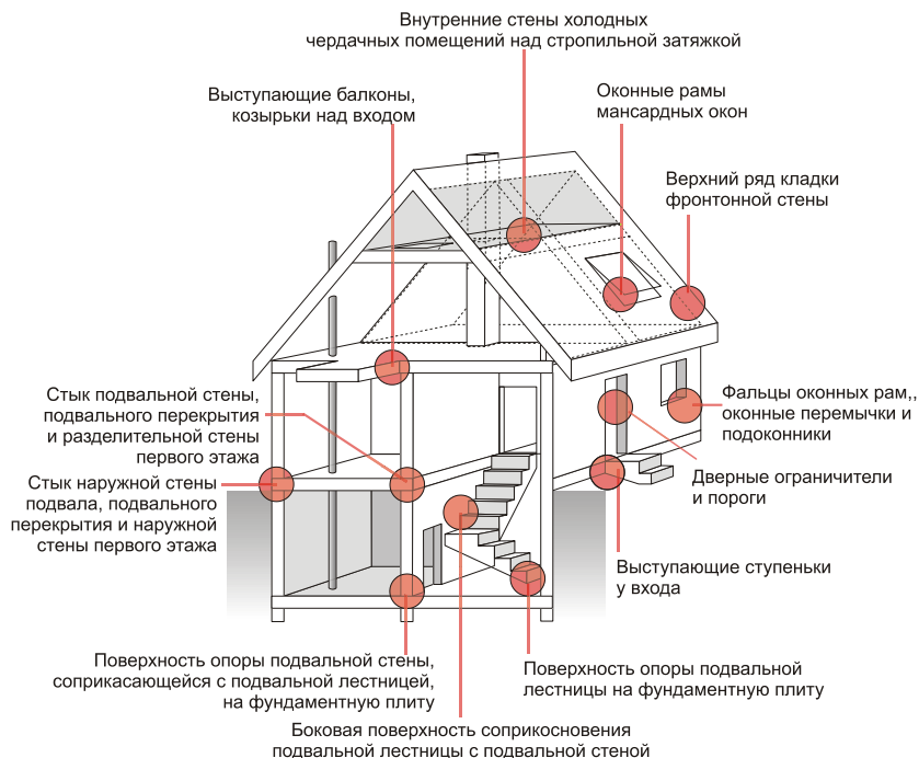
Рис. 2.13. "Тепловые мостики", наиболее часто встречающиеся в жилых домах. В этих местах требуется предпринимать особые меры предосторожности и обращать на них особое внимание при проектировании
