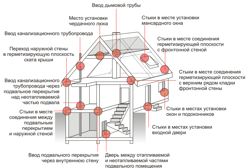
Рис. 2.36. Негерметичности чаще всего встречаются на стыках и переходах между конструктивными элементами здания, особенно в тех случаях, когда не предпринимается никаких специальных мер по их уплотнению (штукатурные работы, проклеивание, изолирующие ленты и т. д.)
